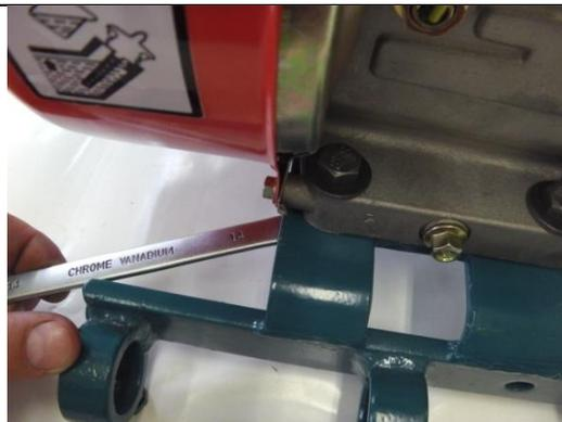
Закрепить болтами ключом -14 мм.
