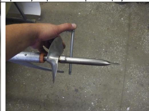
Установить винт на вал привода.
