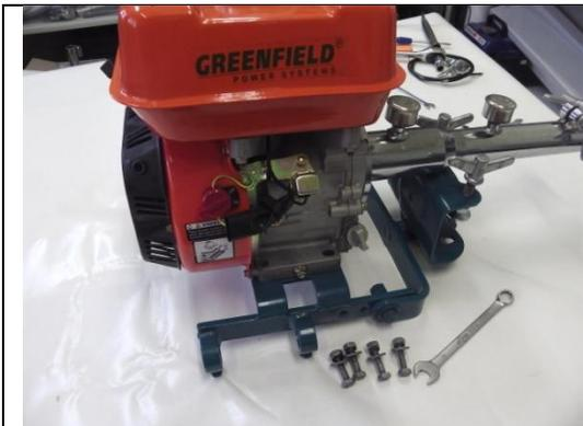
Установить мотор на площадку рамы.
