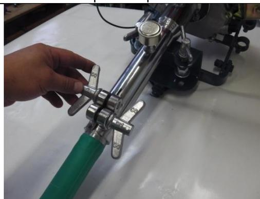
Вставить вал трансмиссии в муфту до зацепления вала с переходной гайкой.
